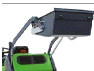
SYSTÈME DE DECHARGE HYDRAULIQUE DU BAC À DÉCHETS
